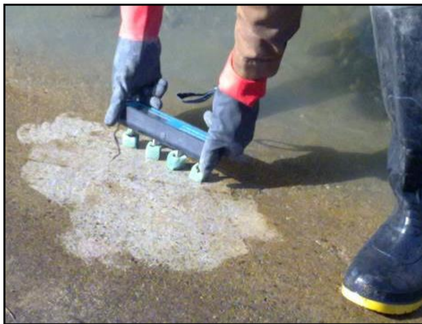
شکل ۲- تعیین مقاومت الکتریکی به روش چهار نقطه‌ای در صحرا
