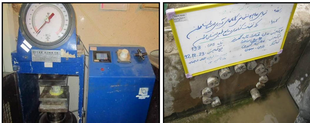
شکل ۳- مغزه‌گیری از پوشش بتنی کانال‌های مورد ارزیابی و تعیین مقاومت فشاری آنها
