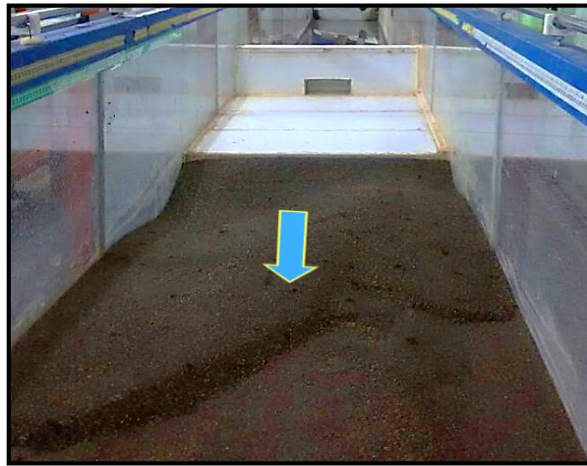
شکل ۱۳- نمای آزمایشگاهی پروفیل آبشستگی در عرض کانال در پایین دست سرریز خطی با دریچه Fig. 13. Experimental view of scour profile at across of downstream labyrinth spillway-gate
