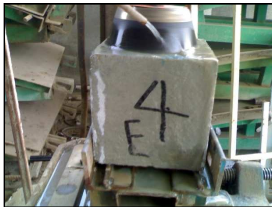
شکل ۱- نمونه بتن در حال ساییش با استفاده از دیسک چرخان
