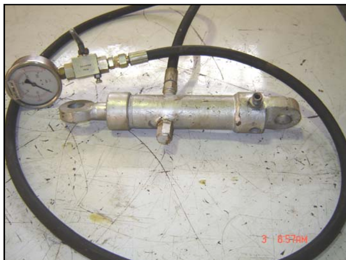
شکل ۴- دینامومتر هیدرولیکی جهت سنجش مقاومت کششی
