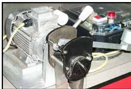
شکل ۳- سفیدکن آزمایشگاهی مدل MCGILL MILLER
