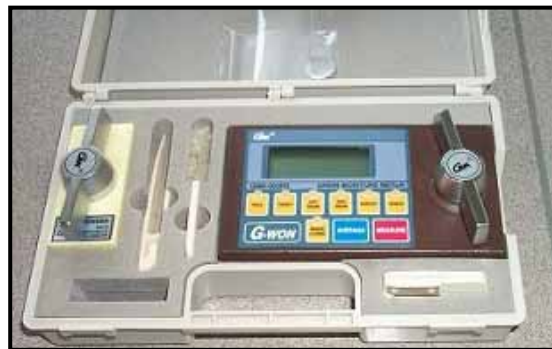
شکل ۲- رطوبت‌سنج دیجیتال مدل GMK-303RS
