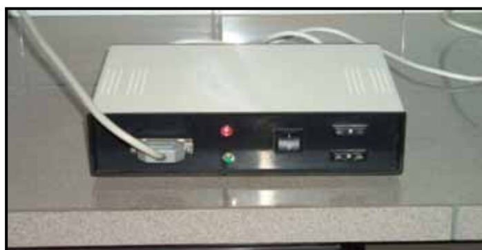
شکل ۵- توان سنج ساخته شده جهت اندازه گیری انرژی خالص مصرفی
